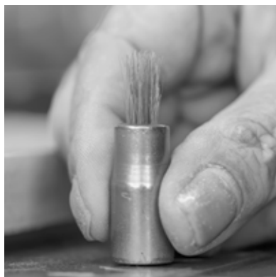
2. Stoßen des Haargutes in einer Messingbüchse Tapping of the hair upside down in a brass cup Pousser les poils dans une godet en laiton Spingere i peli in un bossolo di ottone
